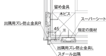
出隅部 (スチール出隅+出隅用ズレ防止金具)
